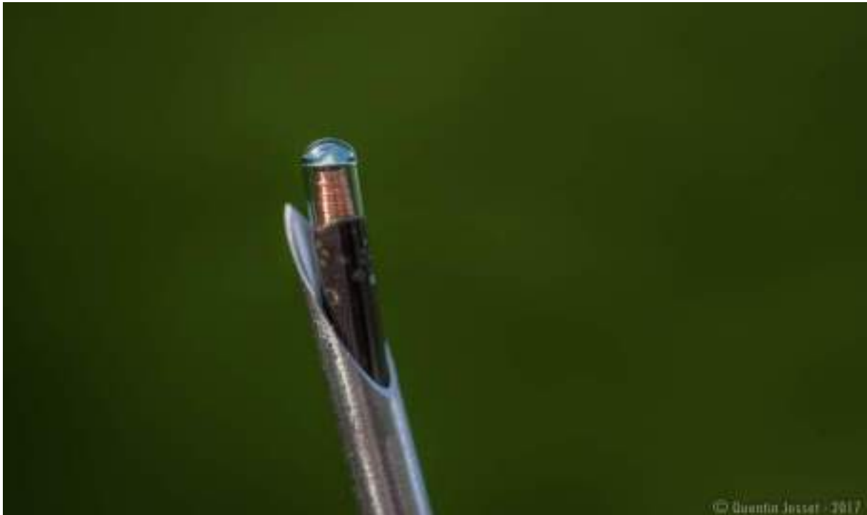
Figure V.3. Marque individuelle passive de type PIT-tag (12 mm).
